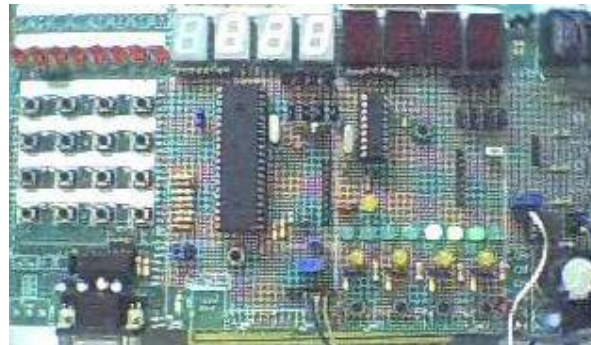
Figura 1. ProtoLabVadEletrônica projetado para o ensino técnico de eletrônica
