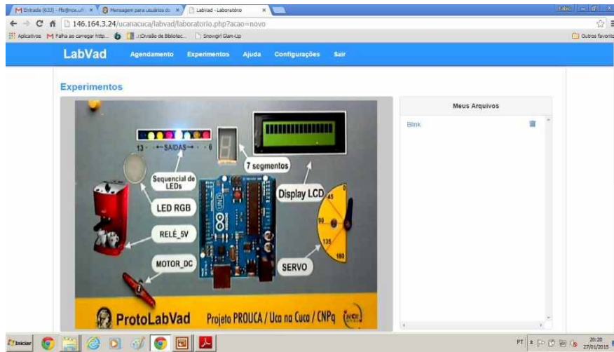
Figura 3. ProtoLabVadRobótica sendo utilizado via web (Abril de 2015)
