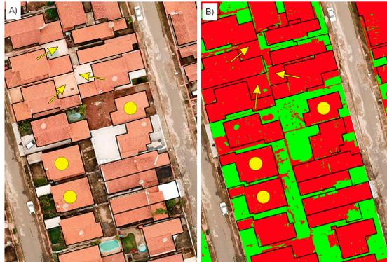
**Figura 6. Avaliação da exatidão da classificação obtida a partir do experimento GEOBIA HARALICK. A) limites dos telhados vetorizados: setas amarelas indicam piso das casas e Os círculos amarelos indicam telhados cuja classificação foi precisa. B) cor vermelha indica telhado e a verde não-telhado. As setas indicam alguns erros de classificação.**
