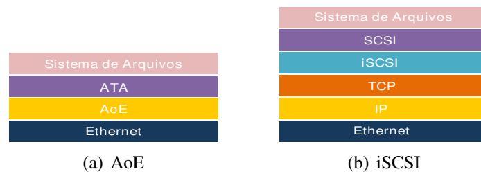
Figura 1. Comparação entre os protocolos AoE e iSCSI.
