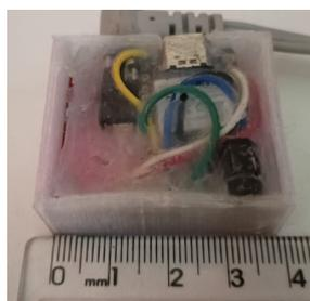
**Figura 4. Foto do dispositivo encapsulado na caixa plástica, medindo 40 mm x 34 mm x 15 mm, com massa total de 22 g.**
