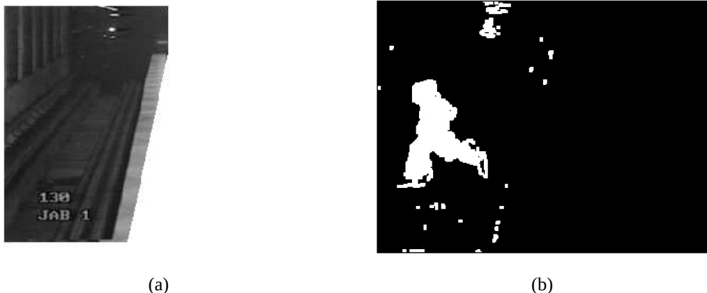
Figura 6: (a) Fundo a ser subtraído e área delimitada pela máscara. (b) Exemplo de uma região de interesse obtida com limiar de subtração de fundo igual a 20.
