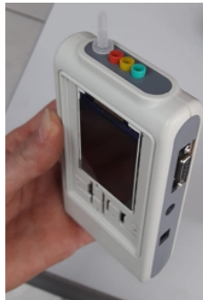
Figura 1. Monitor multiparâmetros MP3.5, para registro do ECG. Fonte: Empresa.
