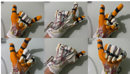
Figura 5. Protótipo da luva inteligente com sensores instalados.
