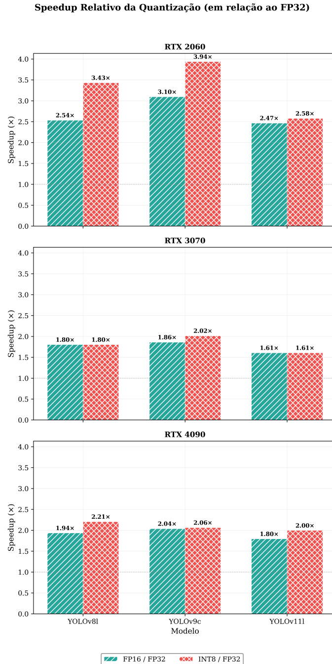
Figura 4. Speedup relativo da quantização FP16 e INT8 em relação ao FP32 para cada modelo e GPU.
