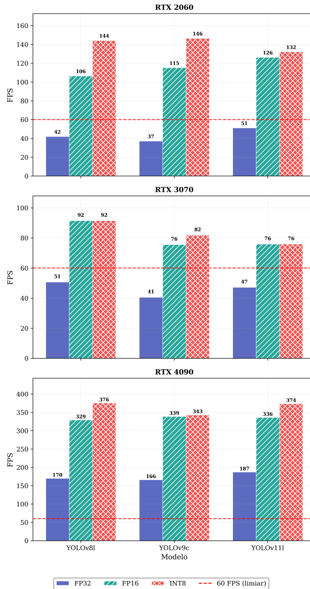
Figura 3. Taxas de inferência (FPS) por modelo e nível de quantização em cada GPU.
