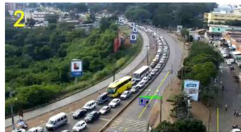
Figure 6. Contagem de pedestres realizando travessia de risco.
