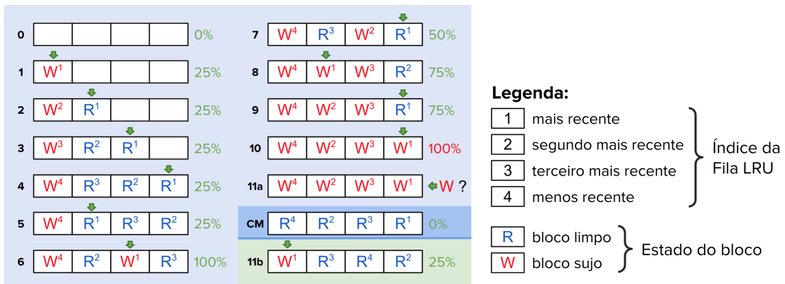
Figura 4. Política de Substituição de Cache de DONUTS.
