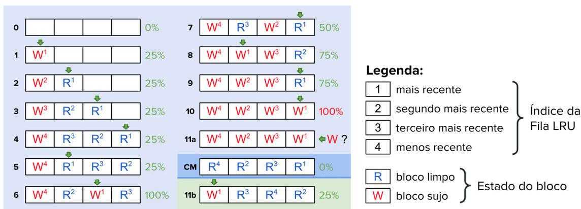
Figura 4. Política de Substituição de Cache de DONUTS.
