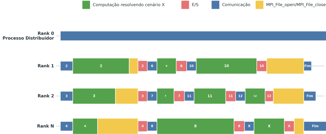
Figura 3. Linha de tempo da simulação final do SDDP com MPI-IO: os ranks trabalhadores executam cenários, sincronizam na abertura coletiva, realizam escritas independentes e sincronizam no fechamento.
