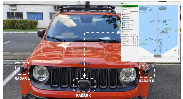
Fig. 4. Visualização dos clusters de radar no software RadarVisual
