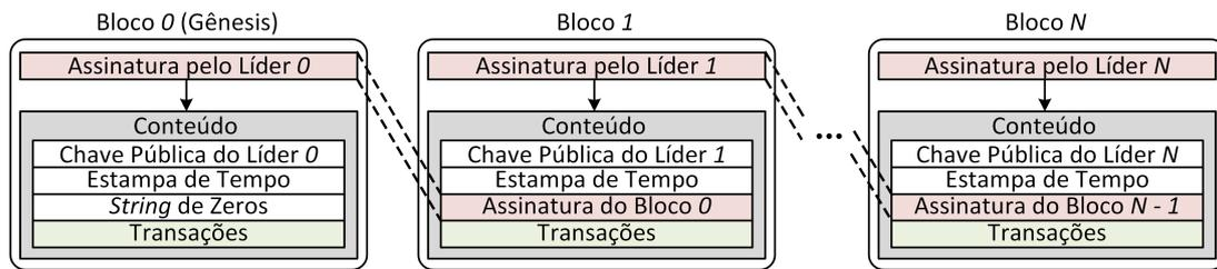
**Figura 3: A estrutura da corrente de blocos desenvolvida para o SINFONIA. A assinatura do líder do bloco atual conserva as mesmas propriedades de uma função resumo (*hash*) criptográfica e também garante a autenticidade do bloco.**
