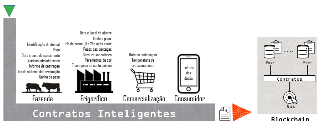
Figura 5. Esquema de desenvolvimento do modelo de monitoramento, contendo as partes que integram o contrato inteligente, os dados a serem inseridos por cada uma das partes e a permissão de leitura dos dados pelos consumidores.
