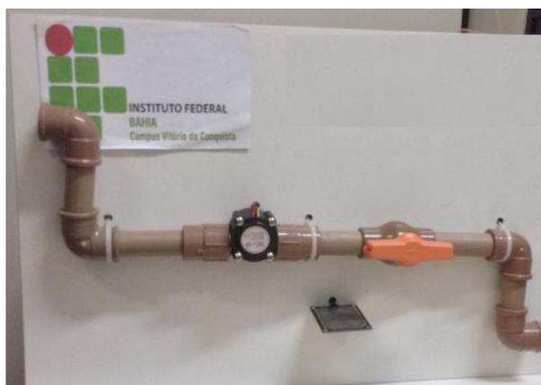
Figura 1. Protótipo com sensores de vazão e umidade
