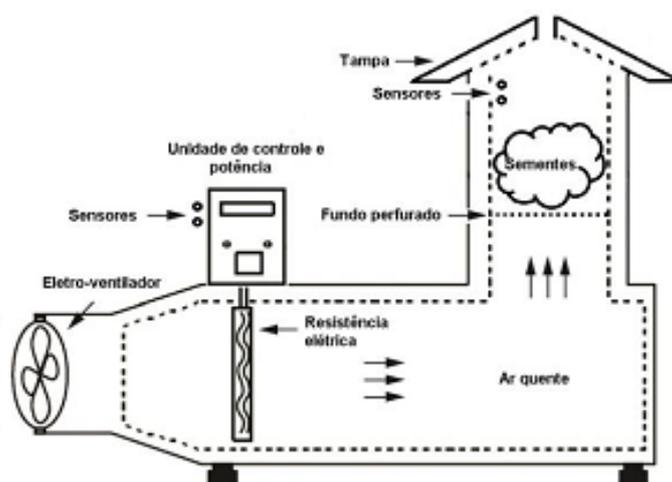
Figura 1. Secador de Sementes e Componentes. Modificada de [Silva et al. 2014].
