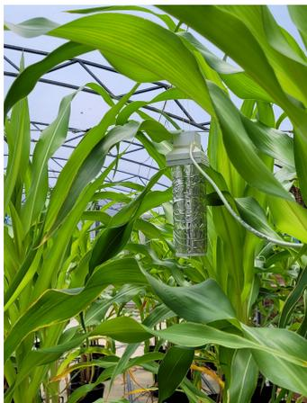
Figura 2. Psicrômetro Aspirado Instalado
