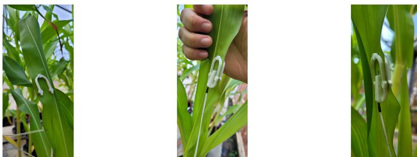
**Figura 1. Sensores de folha instalados**
