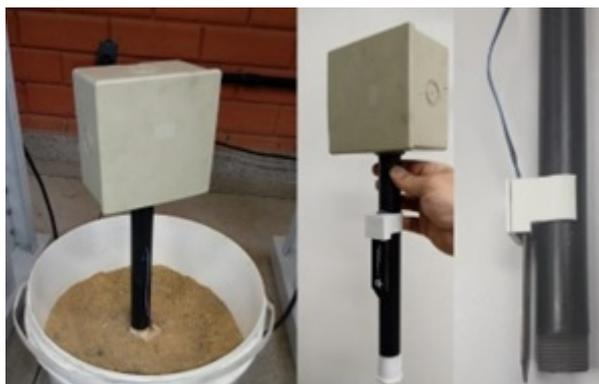
**Figura 7. Módulo Protótipo para avaliação da eletrônica e construção da curva de calibração.**
