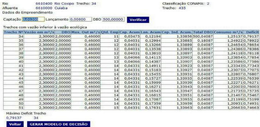
Figura 3 – Tela do sistema mostrando características de alguns trechos do rio Coxipó e identificação do trecho com o maior déficit de vazão.
