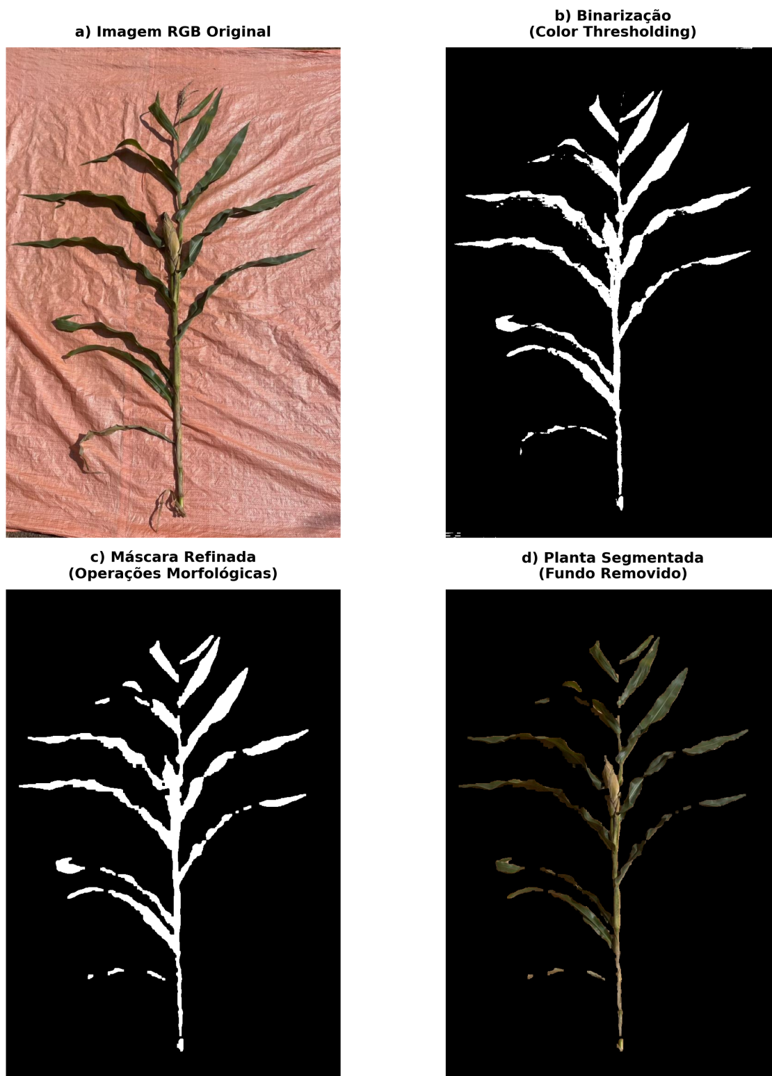
Figura 1. (a) imagem RGB original; (b) máscara binária gerada pelo Color Thresholding; (c) máscara refinada após operações morfológicas de abertura e fechamento; (d) material vegetativo isolado.
