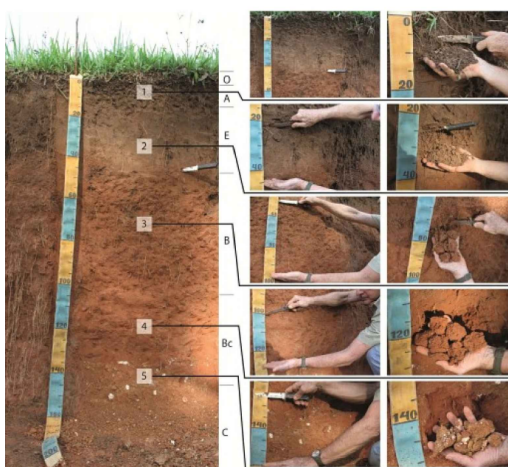
Figura 1. Aspecto de um perfil de solo e verificação tátil de seus horizontes. Fonte: [Lepsch 2011]
