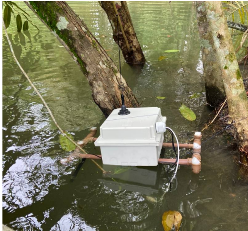
Figura 2. Nó sensor implantado na superfície do lago, no INPA - AM. A caixa impermeável condiciona o ESP32 Heltec V2 e chips dos sensores físico-químicos, com a antena LoRa posicionada na parte superior da caixa.
