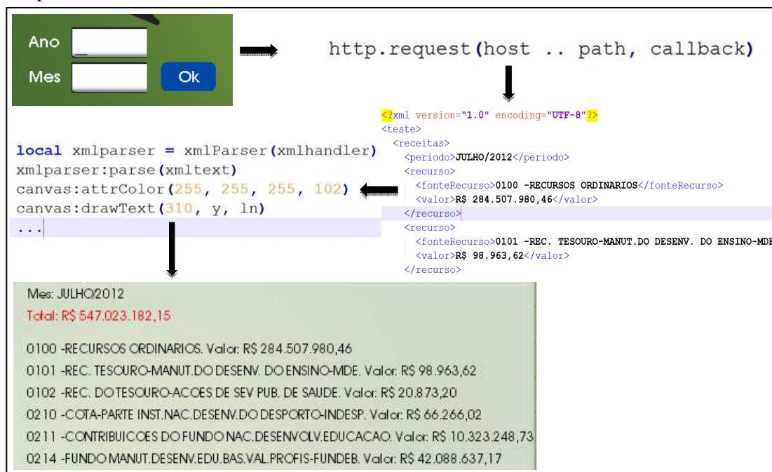
Figura 3. Descrição da Interação da aplicação Lua e a aplicação web desenvolvida em PHP
