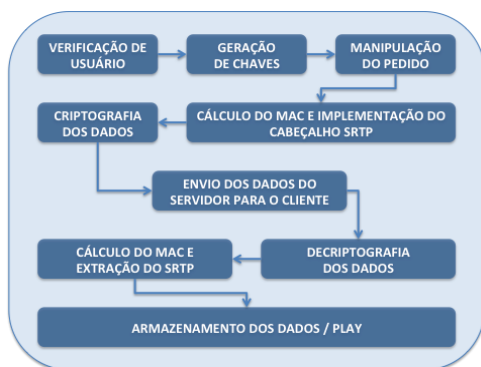
Figura 2: Esquema de segurança de transmissão segura de conteúdo multimídia. Fonte: Adaptado de [14].
