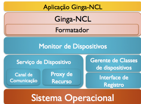
Figura 2. Arquitetura de software do módulo de integração com múltiplos dispositivos com suporte à extensão de classes
