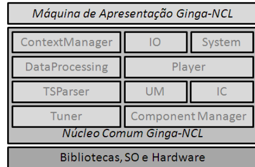
Figura 8 - Visão Geral do Ginga-NCL para dispositivos fixos
