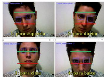
Figure 2: Layout do VisiUMouse: telas de rastreamento e processamento do deslocamento dos olhos.
