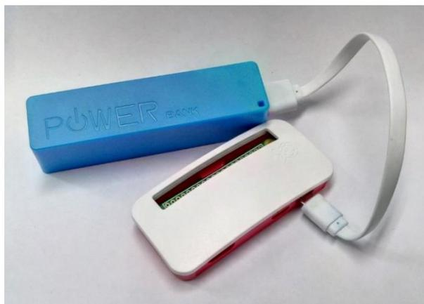
**Figura 3: Raspberry Pi Zero W e carregador portátil para alimentação da placa.**
