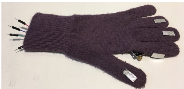
Figure 1: Protótipo da luva SliClick: são apresentados 4 contatos secos (dedo polegar, indicador, médio e anelar) e o diodo laser na parte lateral do dedo indicador.
