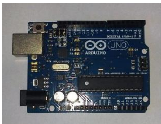
Figura 4. Placa Arduino (UNO R3) utilizada no Projeto.
