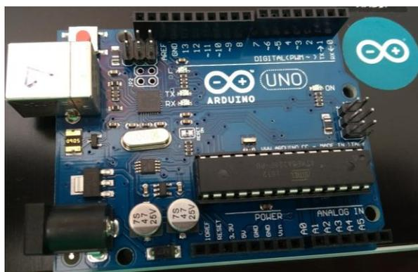
**Figura 1. Placa Arduino Uno utilizada pelo grupo**
