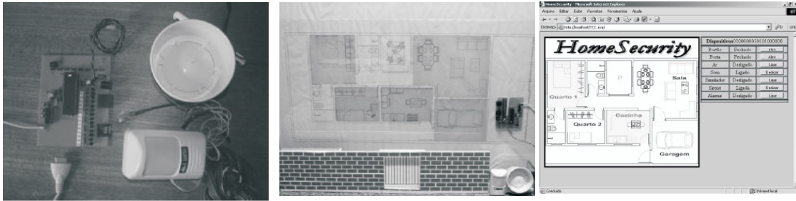
Figura 2. Protótipo da central de alarme, maquete para teste e planta controlada remotamente
