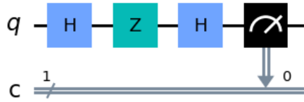
Figura 3. Circuito do IMZ-Z.
