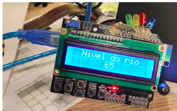
Figura 1. Monitoramento do nível da represa pelo Arduino.
