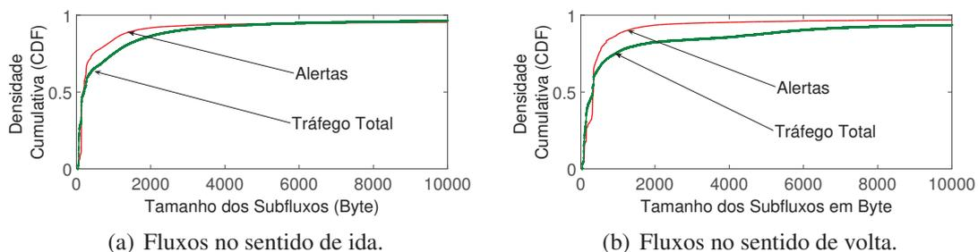
**Figura 8. Função de Densidade de Probabilidades Cumulativa (CDF) para a distribuição do volume em *bytes* por subfluxo em cada fluxo. Fluxos que geram alertas tendem a ter menor volume em *bytes* trafegados em subfluxos.**
