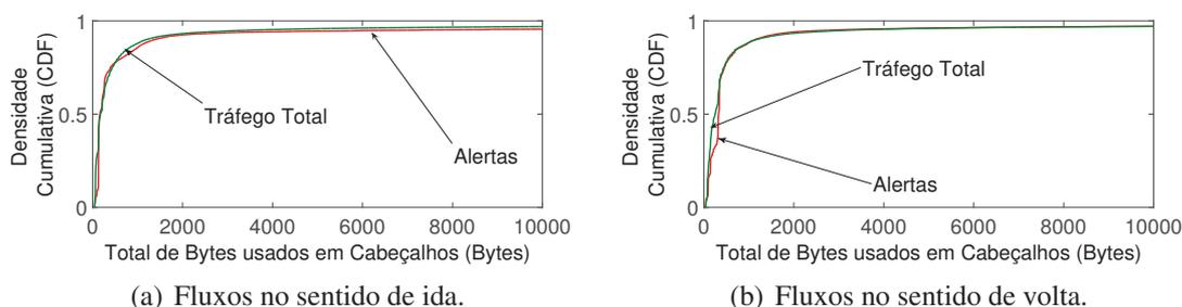
**Figura 9. Função de Densidade de Probabilidades Cumulativa (CDF) para a distribuição do volume em *bytes* dos dados trafegados em cabeçalhos. O comportamento do tráfego que gera alertas é muito semelhante ao tráfego total.**
