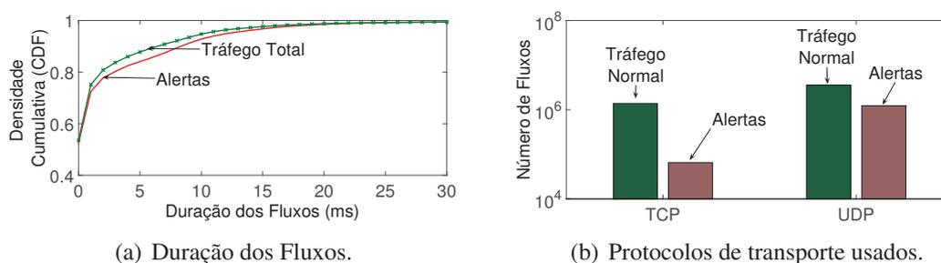
**Figura 5. Função de Densidade de Probabilidades Cumulativa (CDF) para a distribuição da duração dos fluxos em ms e número de fluxos por protocolos de transporte. a) Os fluxos que geram alertas tendem a ser de menor duração que os fluxos totais. b) Os fluxos legítimos com UDP são numerosos em função do DNS (porta 53 UDP). O número de alertas em UDP é mais de 10 vezes maior que em fluxos TCP.**
