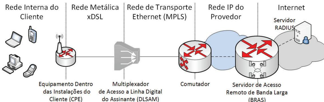
**Figura 1. Topologia típica da rede de acesso banda larga. A conexão entre o Home Gateway e a Internet é autenticada, contabilizada e registrada pelo servidor Radius. O tráfego é encapsulado em sessões PPPoE (Point-to-Point Protocol over Ethernet) entre a casa do usuário e o BRAS (Broadband Remote Access Server). A inspeção e a coleta do tráfego ocorre após o BRAS.**
