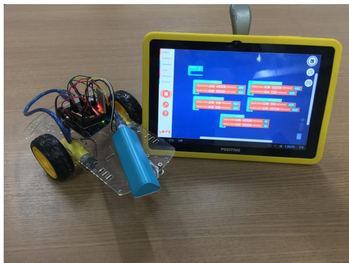
**Figure 1. Protótipo integrado ao app Lofi Blocks.**
