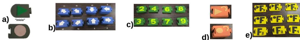
Figura 2. Tipos de blocos de programação: a) controle (bloco “inicio” e bloco “fim”); b) deslocamento; c) números; d) repetição; e) procedimentos.
