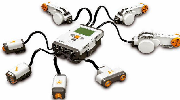
Figura 1. Bloco NXT do kit de robótica e seus acessórios (Fonte:<http://arstechnica.com>)
