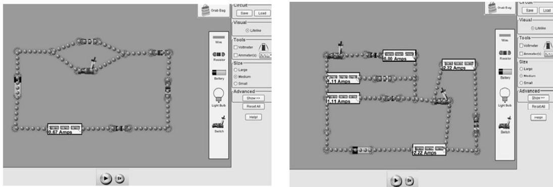
**Figura 1: Atividades de simulação 1 (figura da esquerda) e 2 (figura da direita) para construção de conhecimentos relativos à associação de resistores em série e em paralelo de resistores respectivamente, através do uso do software *Circuit Construction kit dc*, do site *Phet* (<http://phet.colorado.edu/en/simulation/circuit-construction-kit-dc>).**
