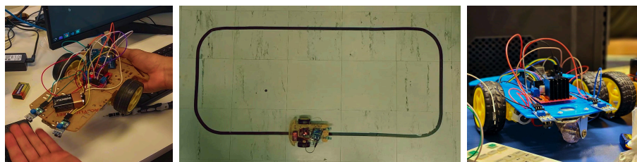
Figura 3. Robôs seguidores de linha construídos pelos alunos
