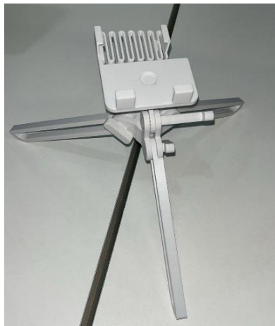
Figura 2. Estrutura desenvolvida pelos estudantes para estabilização do smartphone durante a captura das imagens. Acervo da pesquisa (2026).
