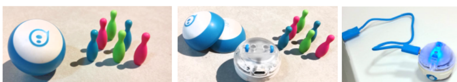
Figura 1. Sphero Mini e vista da parte interna.
