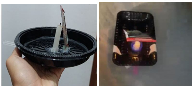
Figura 1. Barquinhos Pop-Pop com bases redonda e retangular, respectivamente.
