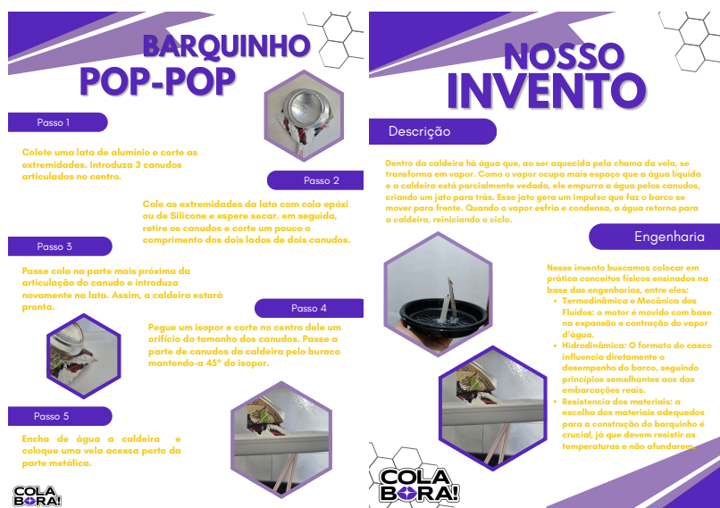
Figura 4. Folheto detalhando o funcionamento do barquinho Pop-Pop.
