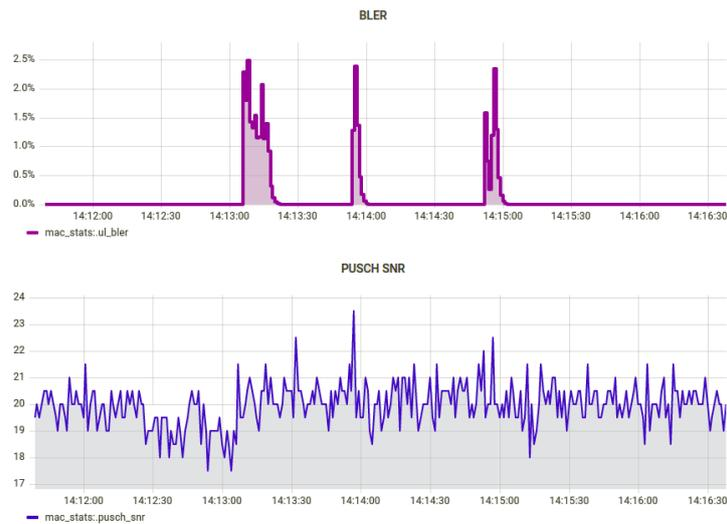
**Figura 3. BLER e SNR do PUSCH: *streaming* com UE COTS usando o FlexRIC.**
