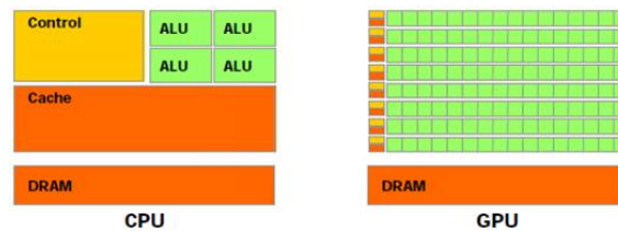
Figura 1. Diferença no espaço gasto no chip de uma CPU e uma GPU
