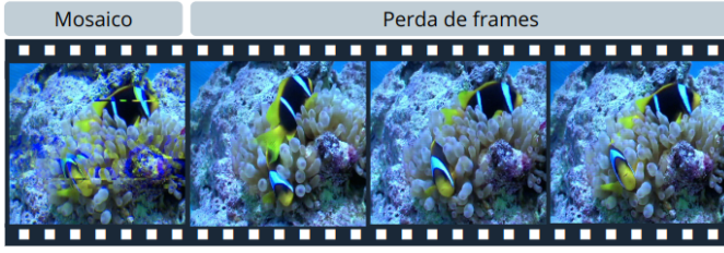
Figura 3. Sequência de frames anômala com defeitos de mosaico e perda de frames simulados.
