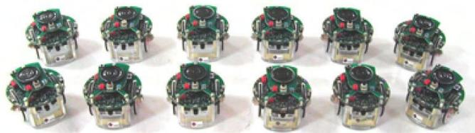
**Figura 6. Doze robôs *e-puck* utilizados nos experimentos.**
