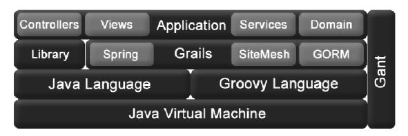
Figura 2.5. Arquitetura do Grails Framework (Fonte: [29])
