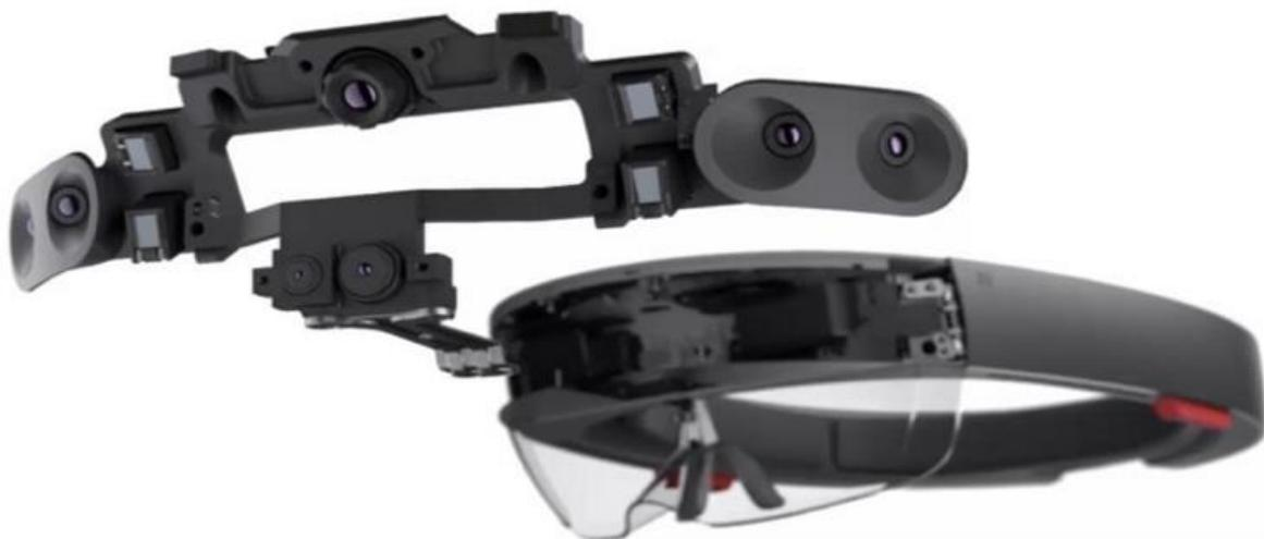
Figura 3.8: Componente de câmeras de visão em profundidade do Hololens.
