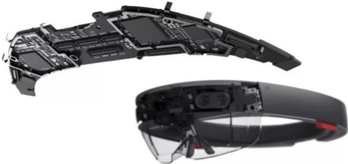
Figura 3.9: Sistema de processamento (CPU, GPU e HPU) do HoloLens.
