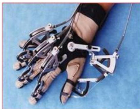
Figura 5.4. Imagem de uma luva com exoesqueleto
