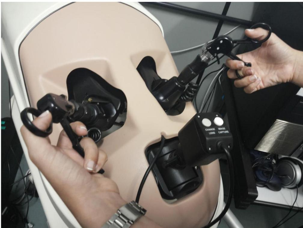
Figura 15.6: Usando o LapVR como dispositivo tátil. Interação normal do usuário do simulador.
